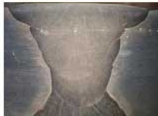
Gambar.4 pengujian Makro etsa untuk melihat karakteristik sambungan las.
