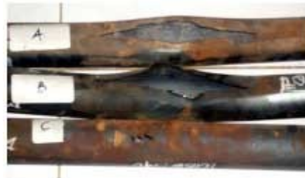
Gambar Pipa A,B dan C yang gagal
